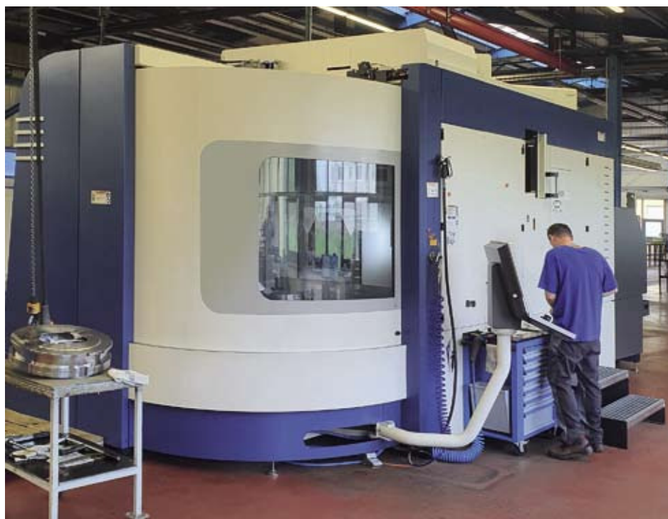
5-Achs-CNC-Fräszentrum für bis zu 600 mm große Werkzeuge 5-axis CNC milling centre for 600 mm large dies
